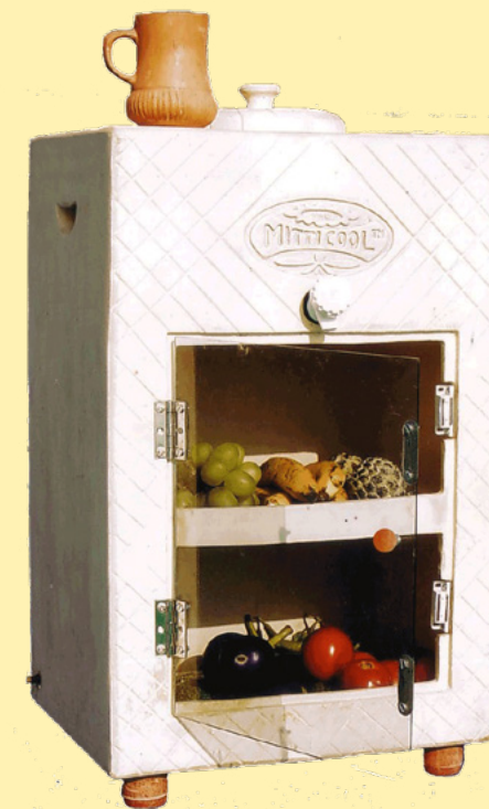
Mitticool: ce réfrigérateur entièrement conçu en argile est équipé d'un réservoir que l'on remplit d'eau fraîche. Avec la chaleur ambiante, l'eau s'évapore puis se condense pour s'écouler sur les parois extérieures, permettant ainsi de conserver les aliments au frais. (photo : © Mitticool)
