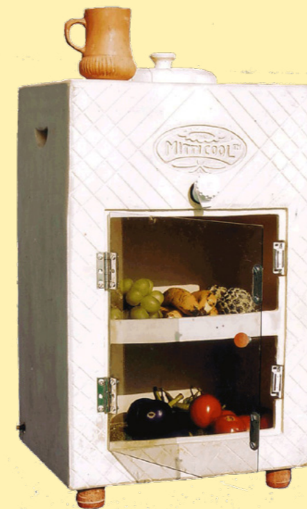
Mitticool: Vanaf de bovenkamer van de kleien kast sijpelt water in de wand van de lagere delen, waar door evaporatie het gestockeerde voedsel koel wordt gehouden (foto: © Mitticool).
